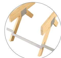
Installation du renfort de la membrure d'âme
